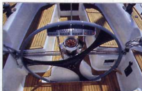
Sopra, il salpancora è interno al gavone. Sotto, la timoneria con la consolle degli strumenti completa e la ruota in carbonio.
