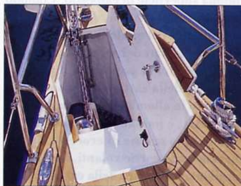
Sopra, il salpancora è interno al gavone. Sotto, la timoneria con la consolle degli strumenti completa e la ruota in carbonio.
